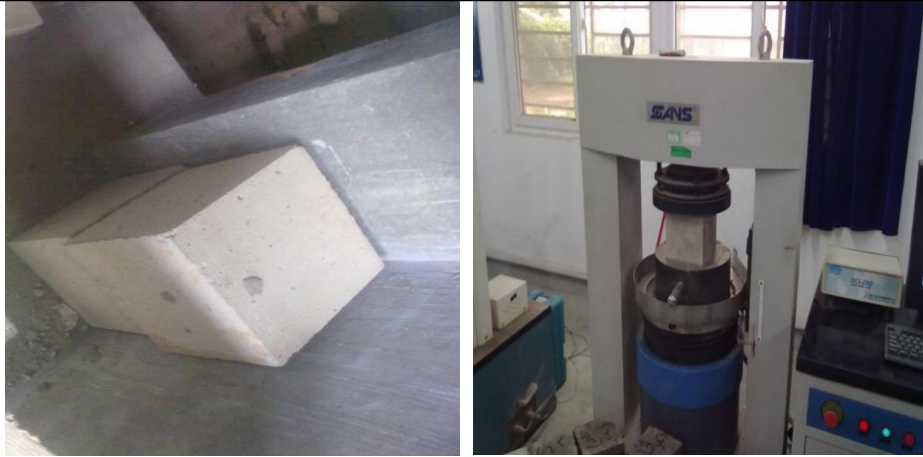
图 4 混凝土抗压强度试验条件
